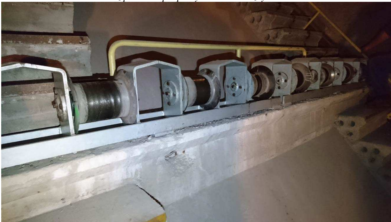
Mezipodesta s podpěrnými rolnami tažných lan
